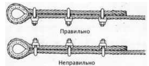
Способы крепления троса к на мачте.
