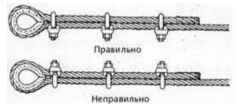
Способы крепления троса к на мачте.
