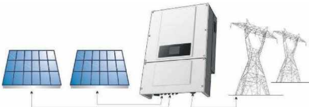
Рисунок 1 Сетевая солнечная электростанция
