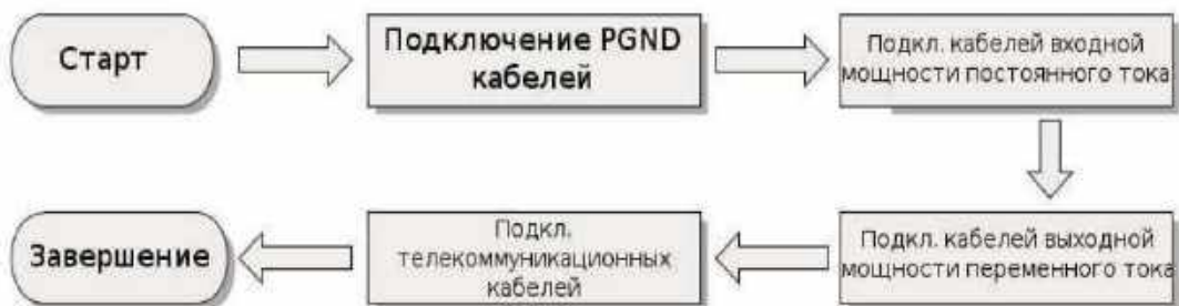
Рисунок 15 Блок-схема для подключения проводов к инвертору
