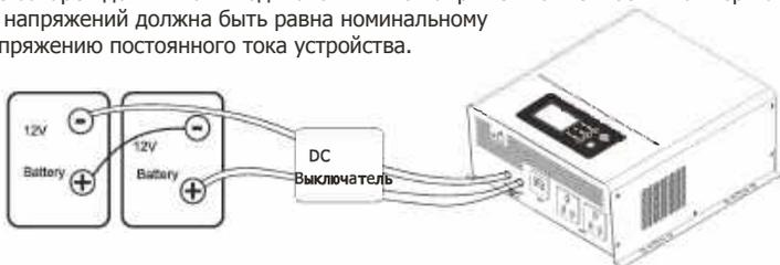
2) Несколько батарей при параллельном подключении
