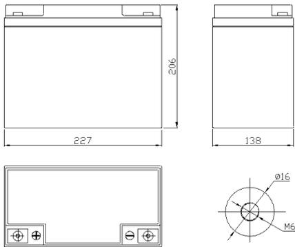
Герметизированные необслуживаемые свинцово-кислотные аккумуляторы MNB серии MM изготовлены по технологии AGM
